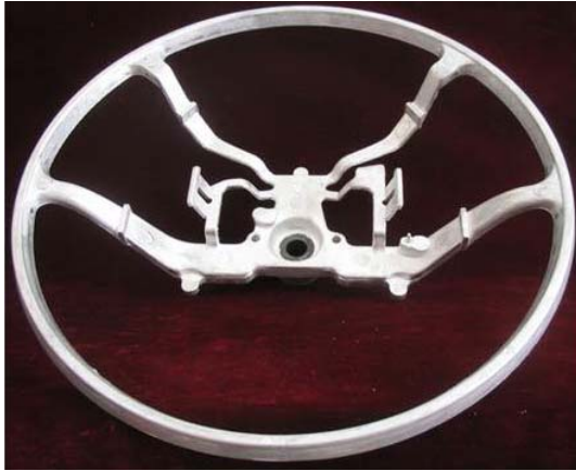
Fig. 2. Armadura de un volante.
