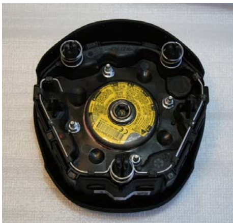
Fig. 4. Módulo airbag (vista frontal).
